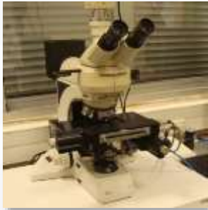
Équipement de contrôle propretés
